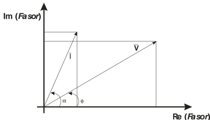
Repare-se que os vectores descrevem um arco de  $(\omega t_1)$  radianos ao fim do tempo  $(t_1)$  e que para cada instante os valores instantâneos de tensão ou corrente são dados pela projecção da extremidade do vector no eixo imaginário.
