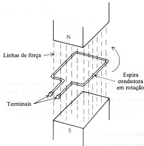
Figura 2: Uma espira girando num campo magnético produz uma tensão ca.
