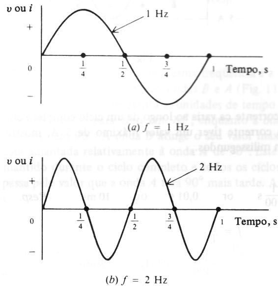
O ângulo de  $360^\circ$  representa o tempo para um período  $T$ . Portanto podemos representar o eixo horizontal de uma onda sinusoidal em unidades de graus eléctricos ou em segundos:
