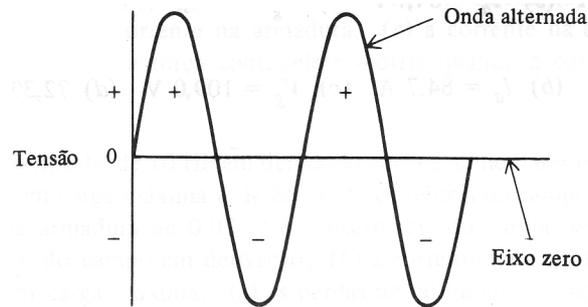
Figura 1: Uma forma de onda de tensão ca.
