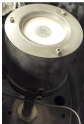
**Figura 4-7: Montagem real da pulverização catódica assistida por magnetron.**
