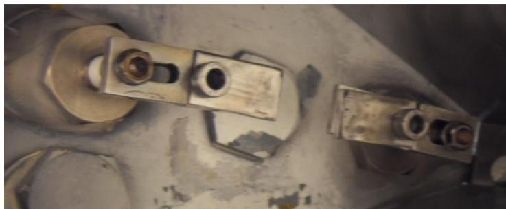
Figura 4-2: Montagem real da evaporação térmica sem recipiente (vista de cima).
