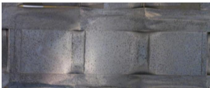
**Figura 5-10: Lâmina com amostra de lítio com proteção de multicamada de titânio testado em meio ambiente.**
