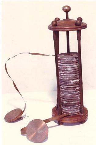
**Figura 2-1: A pilha de Volta [3].**
