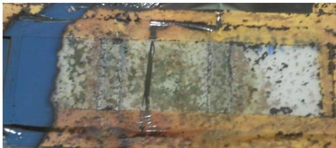
**Figura 5-9: Lâmina com amostra de lítio com proteção de nitreto de titânio testado em meio ambiente.**
