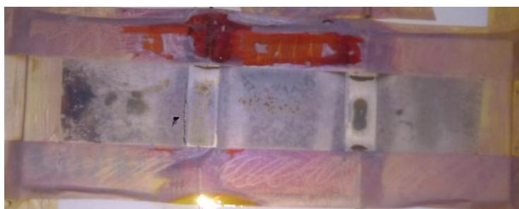
Figura 5-8: Lâmina com amostra de lítio com proteção de oxinitreto de lítio testado em meio ambiente.
