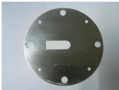
Figura 48 - Máscara usada para depositar o filme de lítio
