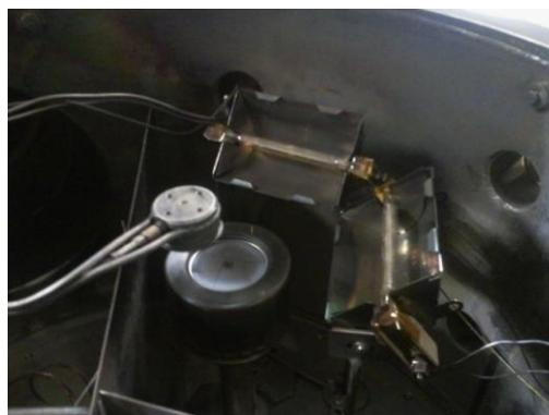
**Figura 65 - Aquecedor de substratos**
