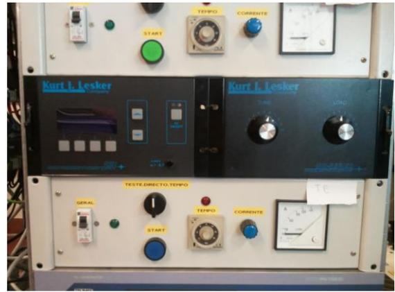
Figura 27 – Fonte de radiofrequência
