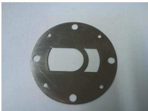
Figura 59 - Máscara usada na deposição dos contactos
