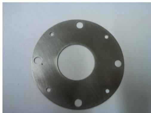
**Figura 45 - Máscara usada na deposição do germânio**
