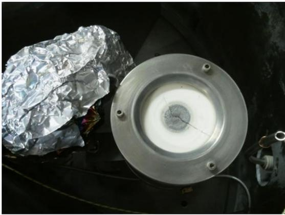
Figura 26 - Magnetron com alvo de  $\text{Li}_3\text{PO}_4$
