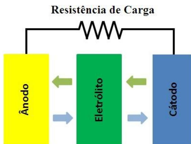
Figura 4 - Componentes de uma bateria e seu modo de operação
