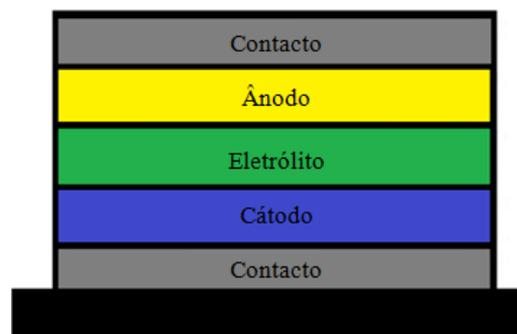
Figura 7 - Bateria de filme fino em stack
