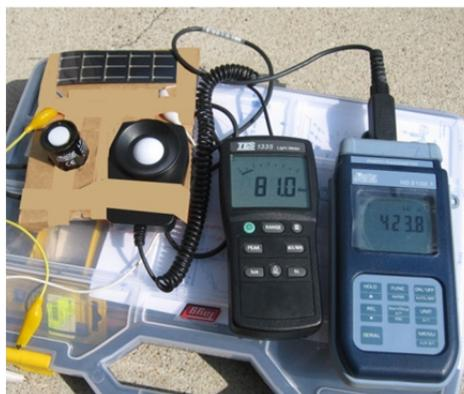
Figura 3.49: Luxímetro (à esquerda) e radiómetro (à direita) com as células no plano do painel fotovoltaico.
