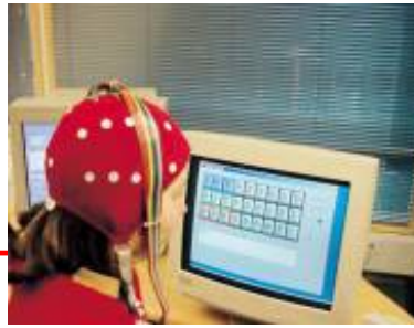
Um dos modelos de interface cérebro-computador: através da touca de eléctrodos, o utilizador escolhe letras com o pensamento e assim pode formar palavras
