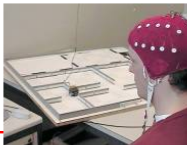
A touca de electrodos capta os sinais electromagnéticos do utilizador e transmite-os a um computador. Este analisa os dados em tempo real e comunica com o robô, que executa o movimento, deslocando-se entre as divisões da maqueta
