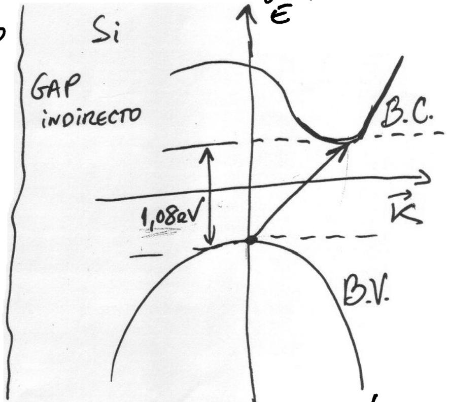
O fundo da B.C. não se encontra directamente ao baixo do topo da B.V. A transição ocorre em passos: i) o electrão absorve um fóton e um fonão (fóton fornece a energia necessária e o fonão a quantidade de movimento  $(\approx 0.05 eV)$ ).
