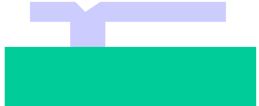
Corrosão da camada de sacrifício
