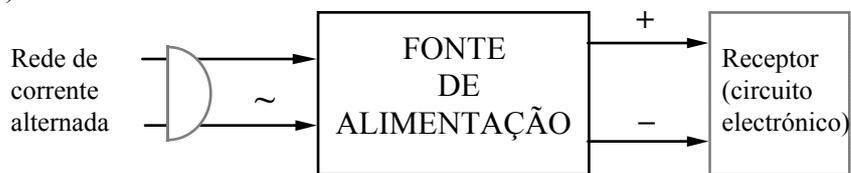
Fig. 4.52 – Fonte de alimentação de corrente contínua.
