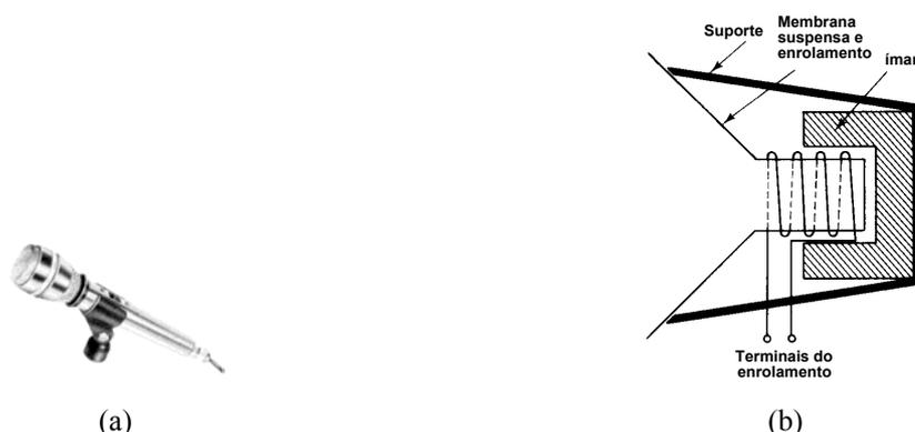
Fig. 3.7 – Microfone dinâmico: a) aspecto exterior; b) estrutura básica.
