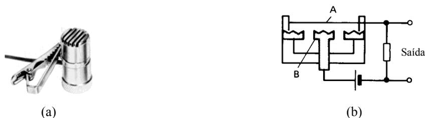
Fig. 3.9 – Microfone capacitivo: a) aspecto exterior; b) estrutura básica
