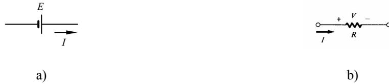
Fig. 2.16 – Potência: a) fornecida por uma bateria; b) absorvida por uma resistência (receptor ou carga)
