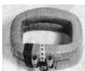
Bobinas L9 do estator
