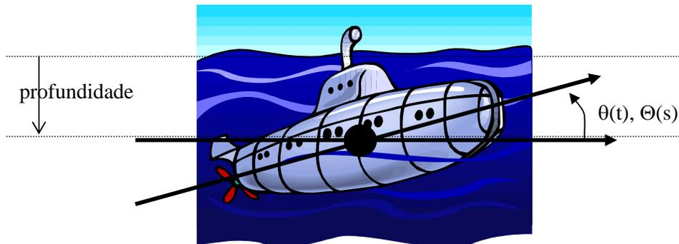
Figura 1.  $\theta(t)$  é a inclinação do submersível, em relação a um referencial, no instante  $t$ .
