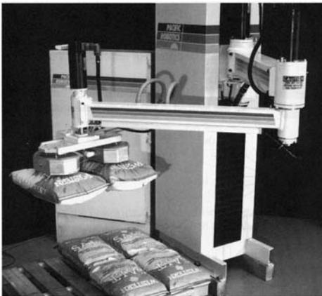
Fig. 1: Robô a vácuo que iça dois sacos de sal em cada operação de transporte. Este é usado para mover sacos de sal de uma posição para outra.
