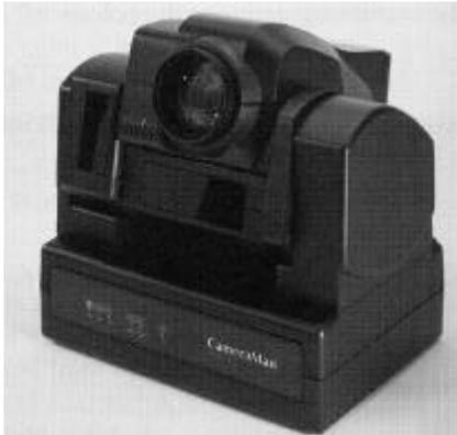
Esta figura mostra uma camera que está equipada com sensores de infravermelhos e que tem a capacidade de automaticamente seguir um indivíduo.
