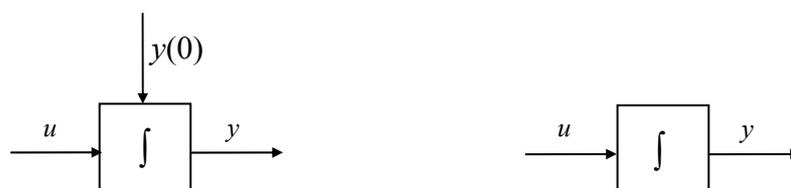
**Figura 2-2** Representações de um operador de integração com condição inicial, usualmente dito apenas um integrador. O valor de  $y(0)$  não é uma variável do modelo propriamente dita, antes reflecte uma situação do sistema, para a qual o modelo vai ser aplicado. Por essa razão, ele é tomado implicitamente na segunda representação.
